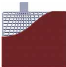
Příklad kladné desky s oxidem olovičitým ( PbO_2 )
